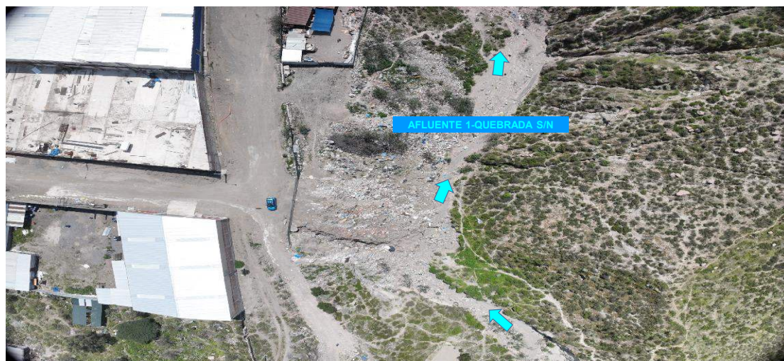
Imagen N° 2. Zona colmatada en el tramo, en donde se observa sedimentación en el cauce del Afluente 1-quebrada S/N.
