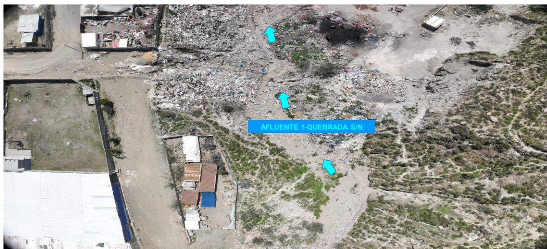
Imagen N° 3. Zona colmatada en el tramo, en donde se observa sedimentación en el cauce del Afluente 1-quebrada S/N.
